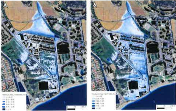
A gauche : inondation du secteur étiré pour une crue 30 ans du Carrubier et maintien du mur digue existant. A droite : inondation pour le même événement, sans le mur digue.
